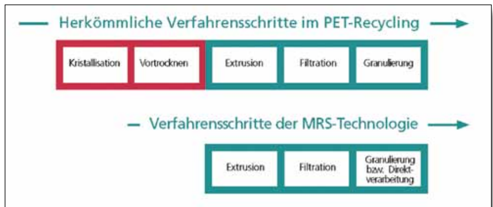
Bild 2: Verfahrensschritte der MRS-Technologie (Werkbilder: Gneuß Kunststofftechnik GmbH, Bad Oeynhausen)
