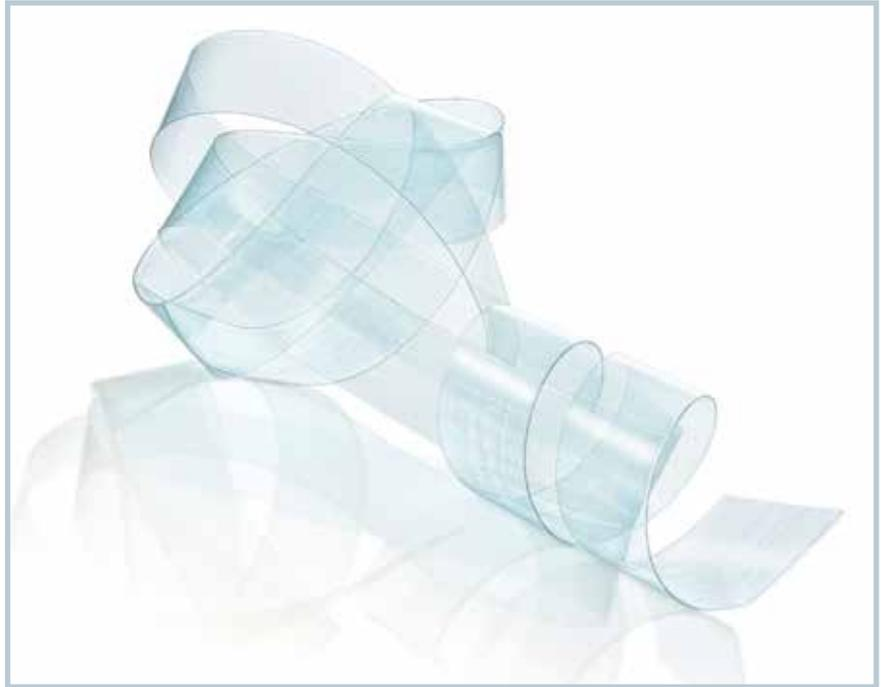
**Bild 2.** Randbeschnitt: Neben Bottle-Flakes und Granulaten wollen viele Verarbeiter auch Mahlgüter aus Stanzgittern und Randbeschnitten direkt verarbeiten können (© Gneuß)
