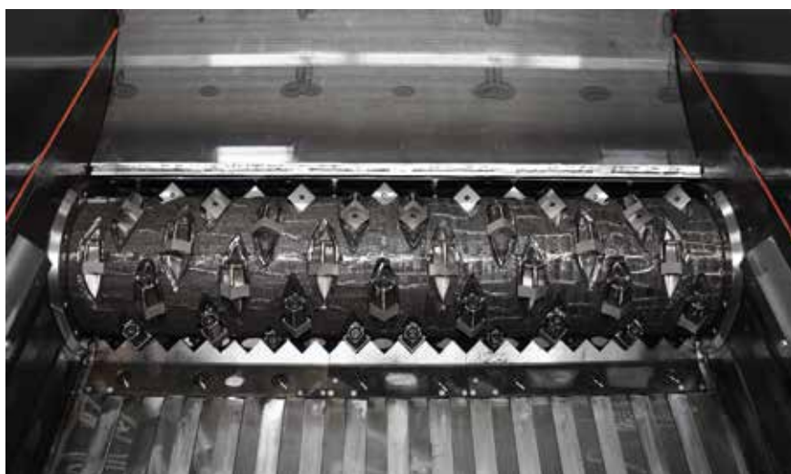
Bild 3. Shredderrotor F-Rotor mit aufgeschweißtem Vautid-Verschleißschutz (Bild: Weima)
